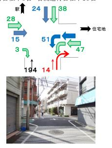
右折時右側通行台数に対する右方向左側通行する 自転車・車両の直進・左折台数及び歩行者を含めたと きの割合0.19、0.13は最小で、右方向からの自転車・ 車両台数を考えると右折時左側通行率は上がるだろう。 しかし、右折前道路の幅員4mに左側通行自転車が2 06台(左側通行率86.2%)であるため、この車列の中 から右折することが難しいという状況が右折時右側通 行を促していると考えられる。
