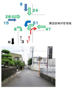
右折時右側通行台数に対する右方向左側通行する 自転車・車両の直進・左折台数及び歩行者を含めたと きの割合0.45、0.42は最大で、右方向左側通行する 自転車・車両台数が右折時左側通行率を低下させて いる可能性が高い。さらに右折前の通行路はゆるやか な下り坂で、しかも右折前の通行路から右方向の自転 車・車両等の通行状況がフェンス越に見えることも右 折時右側通行を促進していると考えられる。
