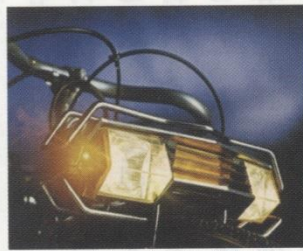
⑧後輪側と前輪側に方向指示器が付いて、右折時に右側の方向指示器が点灯している（出典：「日米富士自転車1972年カタログ」電子フラッシャー）
