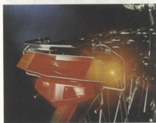
⑧後輪側と前輪側に方向指示器が付いて、右折時に右側の方向指示器が点灯している（出典：「日米富士自転車1972年カタログ」電子フラッシャー）
