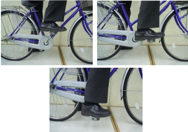
図1 スタート時の踏み込むときのペダル位置 左上：地面と水平な面から上70度 右上：地面と水平 下：地面と水平な面から下70度以下
