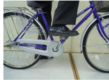
図8-1 発進時のペダルの高さを70度前後にして踏込む場合
