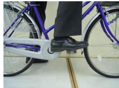
図8-2 発進時のペダルの高さを0度前後(水平)にして踏込む場合
