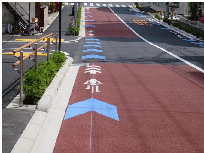
写真3 車道端で路面に自転車イラストと矢羽根を描いて自転車の車道左側端通行を励行させる「車道混在路」
