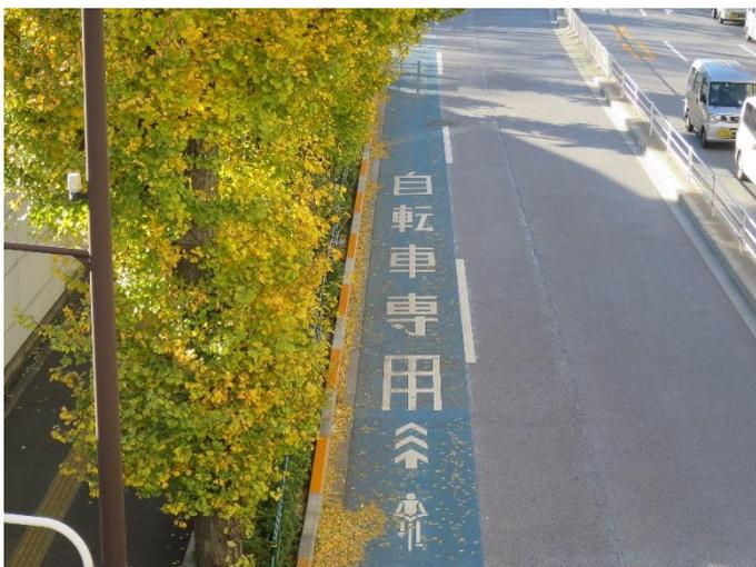
写真2 車道端で路面が青色に塗装された自転車だけが通行できる「自転車通行帯」
