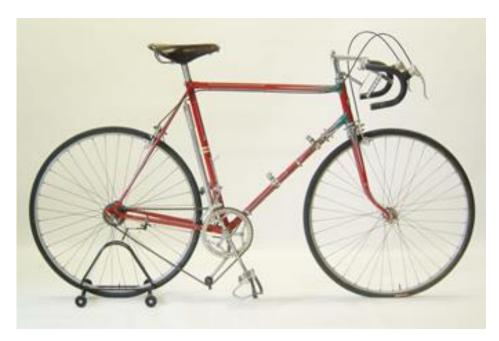
ロードレースに使われる自転車には、チェーンを異なる大きさのギヤに架け替えることができるチェンジギヤ機構が付いています。急な坂道が続くコースではこの機構をいかにうまく利用するか、これも勝負のポイントの1つになります。このためチェーンをスムーズに架け替え、しかもたるみが生じないための機構の開発が19世紀以降続けられています。
